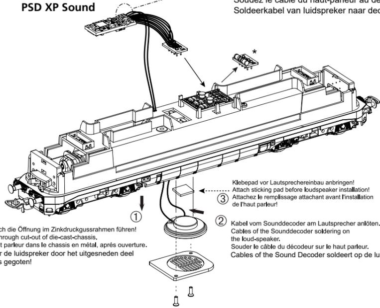
Lautsprecherkabel durch die Öffnung im Zinkdruckgussrahmen führen!
