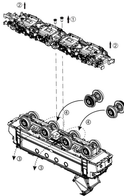
Dem Modell liegen zwei Austauschachsen mit haftreifenbestückten Rädern bei. Diese können bei Bedarf gegen die eingebauten Achsen ohne Haftreifen getauscht werden, um eine höheren Zugleistung zu erzeugen. Beim Einsatz mit Haftreifen kann es unter Umständen zu einer Beeinträchtigung der Stromaufnahme kommen.
