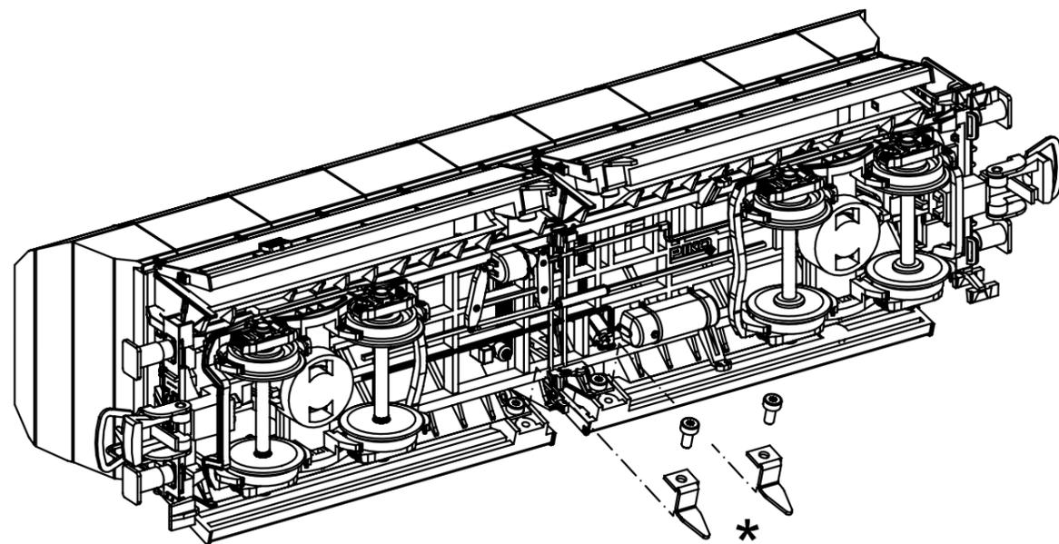
\* Funktionsteile zur Selbstmontage (nur benötigt in Verbindung mit Entladebrücke # 61122) /
