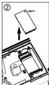
Entfernen Sie vorsichtig den Brückenstecker. Bitte nehmen Sie beide Hände, um ein Verkanten / Verbiegen der Kontakte zu vermeiden. Stecken Sie den Decoder auf die Trägerplatine. Durch seine Bauform lässt er sich nur in passender Position aufstecken. Achten Sie bitte dennoch darauf, dass die Kontakte nicht versetzt eingesteckt werden. Sollten Sie wieder auf Analog umrüsten, gehen Sie in umgekehrter Weise vor. Achten Sie beim Brückenstecker / Trägerplatine auf die Markierung (siehe Bilder)
