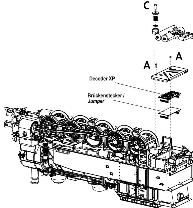
Entfernen Sie vorsichtig den Brückenstecker. Bitte nehmen Sie beide Hände, um ein Verkannten/Verbiegen der Kontakte zu vermeiden. Stecken Sie den Decoder auf die Trägerplatte. Durch seine Bauform lässt er sich nur in korrekter Position aufstecken. Achten Sie bitte dennoch darauf, dass die Kontakte nicht versetzt eingesteckt werden. Sollten Sie wieder auf Analog umrüsten, gehen Sie in umgekehrter Weise vor. Achten Sie beim Brückenstecker/Trägerplatte auf die Markierung (siehe Bilder).
