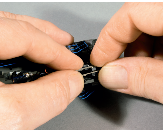
Bevor man den Decoder wie hier festdrückt, prüft man, ob seine Positon zur Lokplatine korrekt ist..
