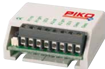
55030 Decoder per scambi Decoder per far funzionare componenti magnetici come scambi, segnali ecc., tramite due indirizzi indipendenti fra loro.
