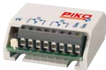
55031 Decoder per accessori Decoder per far funzionare unità elettriche come lampioni, motori, ecc tramite due indirizzi indipendenti fra loro.
