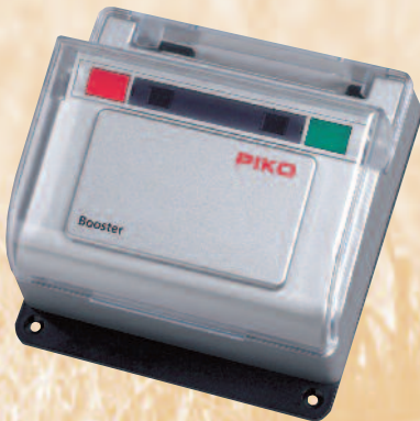
35015 Digitalbooster 189,99 €* Wenn die Leistung der Digitalzentrale bei Ihrer Anlage nicht mehr ausreichend ist, benötigen Sie einen oder mehrere Booster. Diese übertragen die Fahr- und Schaltbefehle der Zentrale in elektrisch getrennte Gleisabschnitte mit eigener Stromversorgung. Eingang: 16-22 V DC/AC, max. 5 A Ausgang: ca. 20 V DCC geregelt, max. 5 A
