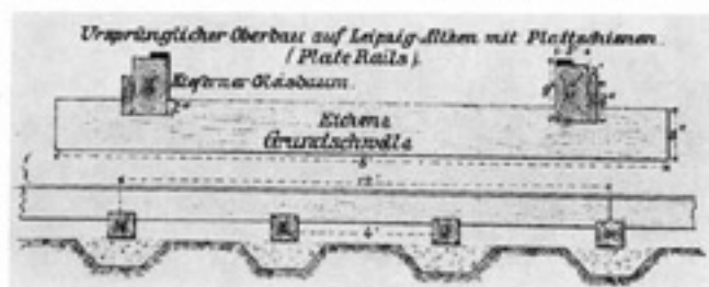
Abb. 8: Ursprünglicher Oberbau (Leipzig-Althen mit Plattschienen (Plate Rails))
