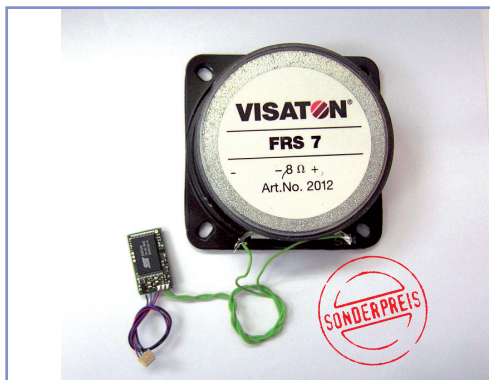
Sound-Modul mit wetterbeständigem Lautsprecher Sound module with weather resistant loud-speaker
